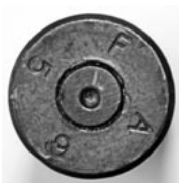
Fondello di un bossolo assemblato a una cartuccia cal. 0,50. Si noti la capsula percossa al centro; in tondo sono incisi l'anno di fabbricazione e le lettere che indicano il lotto
